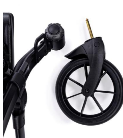
Odblokowywanie przednich kół
