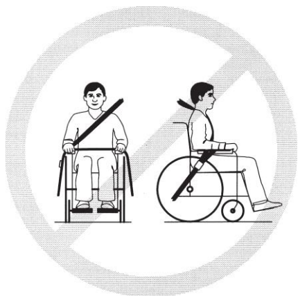
Zdj. 20.7 Niewłaściwe dopasowanie pasa
