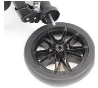
Abb. 9.5.2 Demontage des Rades
