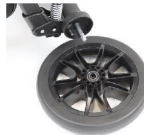
Zdj. 9.5.2 Demontaż koła
