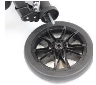
Foto 9.5.2 Desmontaje de la rueda
