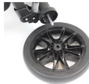
Zdj. 9.5.2 Demontaż koła
