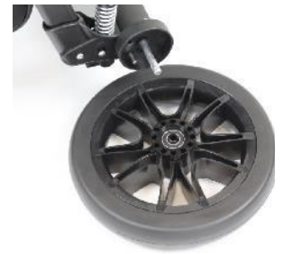
Zdj. 9.5.2 Demontaż koła
