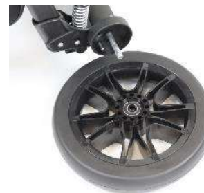
Zdj. 9.5.2 Demontaż koła
